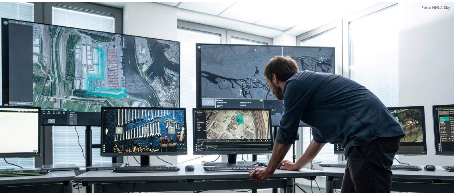
Der Leitstand von HHLA Sky ermöglicht die Überwachung von vielen parallel agierenden UAS durch wenige geschulte Mitarbeiterinnen und Mitarbeiter. Eine wichtige Voraussetzung für wirtschaftlich tragfähige Geschäftsmodelle, die auf Drohneneinsatz basieren
