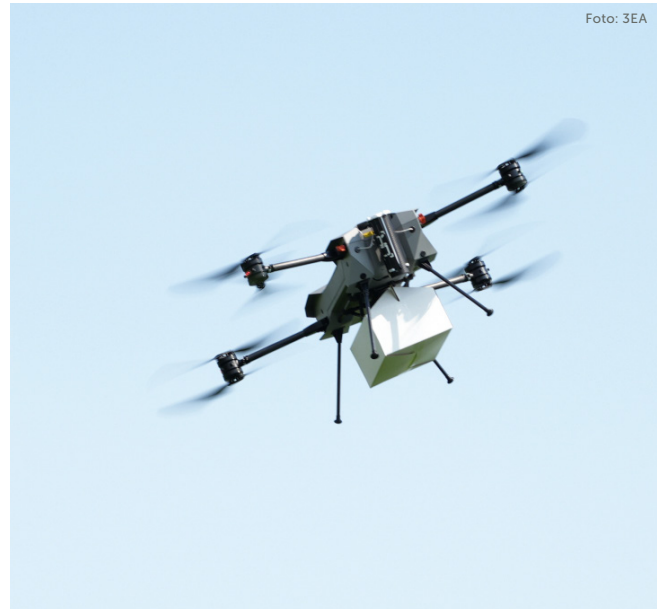
Die Auriol-Drohne von Third Element Aviation (3EA) kann eine Payload von 6,5 Kilogramm Gewicht über einen Zeitraum von 45 Minuten transportieren
